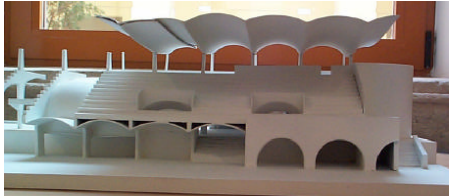
Figura 1.2. Maqueta del Hipódromo de la Zarzuela. Proyecto de E. Torroja (1935).
