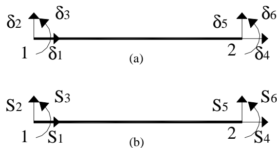
Figura 10. Desplazamientos y solicitaciones en una barra.
